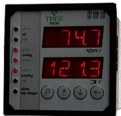
Figura 4. Exemplo de Termômetro Digital com informações de temperatura do óleo e enrolamento.
