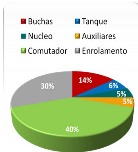
Fig. 3. Estatística das causas para saída de serviço de transformadores com OLTC [1].
