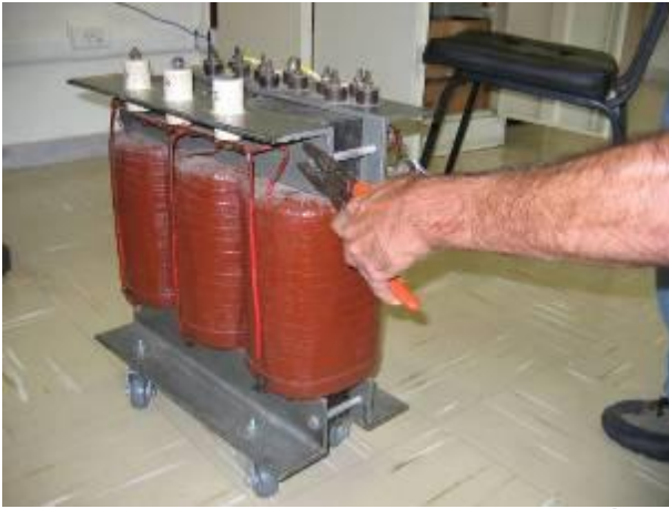
Figura 6 – Proceso de alejamiento de las placas del núcleo del transformador.
