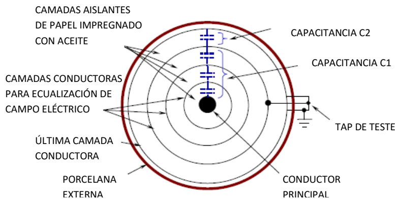
Figura 3 – Representación en corte radial de un bushing capacitivo [5]
