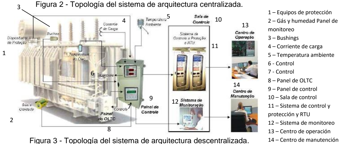
Figura 2 - Topología del sistema de arquitectura centralizada.
