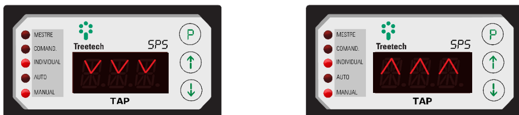
Figura 27 - Display indicando subida ou descida de tap
