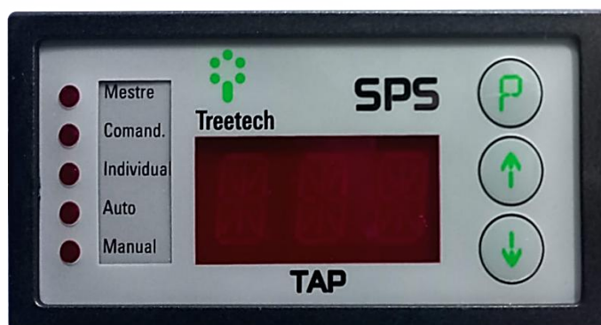
Figura 1 - Supervisor de Paralelismo Síncrono SPS
