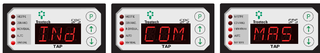
Figura 23 - Display indicando funcionamento no modo individual (IND), comandado (COM) ou mestre (MAS)
