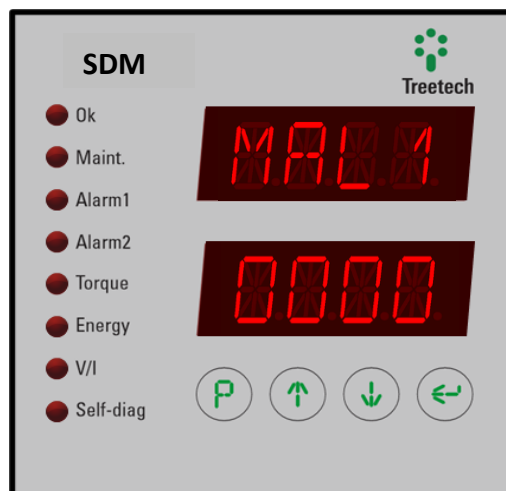
Figura 65 - Indicação de alarme no SDM
