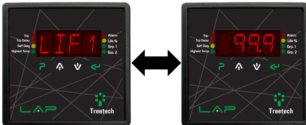
Figura 30 - Indicações de percentual de vida restante do enrolamento
