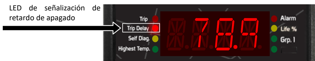
Figura 24 - Indicación de LED de retardo de apagado
