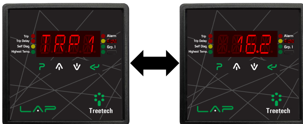
Figura 25 - Indicación de cuenta regresiva para apagar
