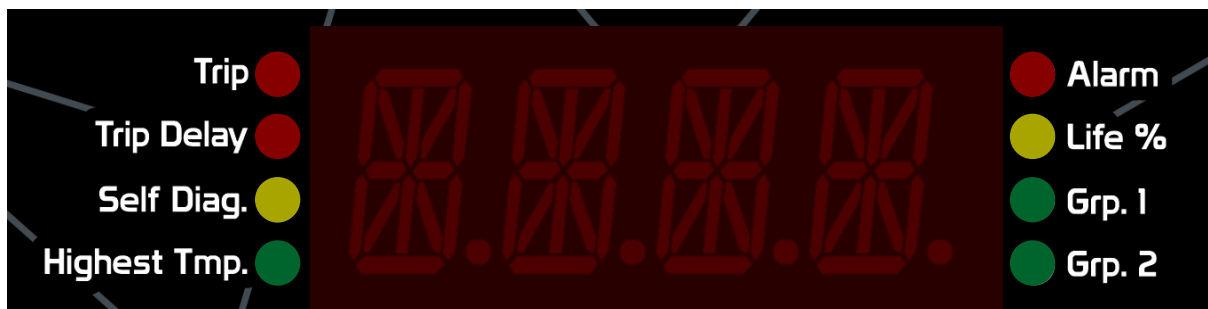
Figura 20 - LEDs de señalización del LAP
