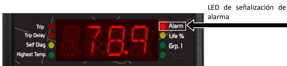
Figura 23 - Indicación de LED de señalización de alarma
