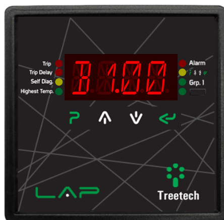
Figura 11 - Pantalla que indica la versión de bootloader
