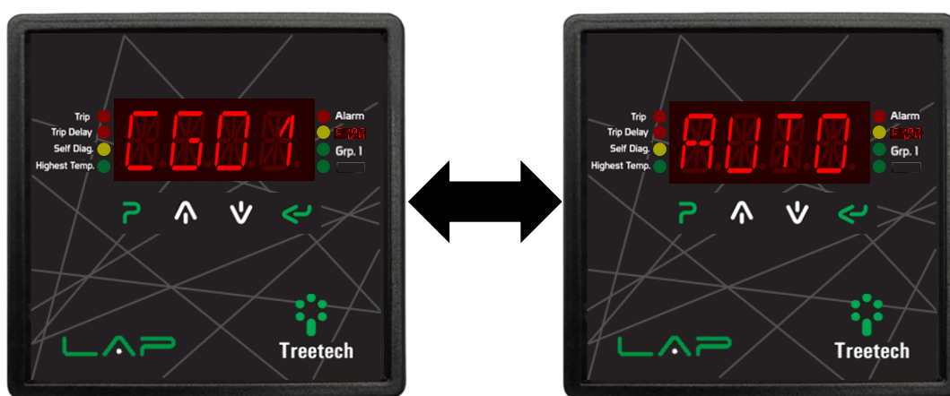
Figura 34 - Grupo de refrigeración 1 alternativamente con el estado actual AUTO
