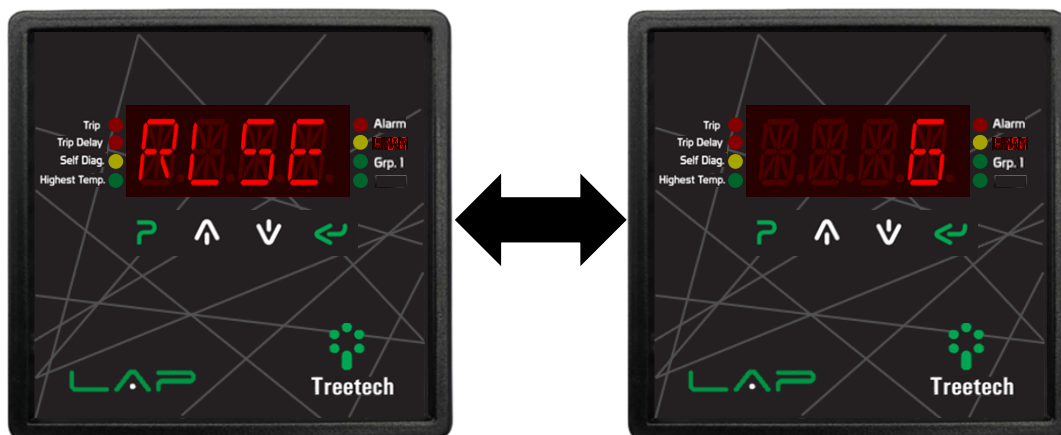
Figura 10 - Pantalla que indica la versión de lanzamiento de firmware
