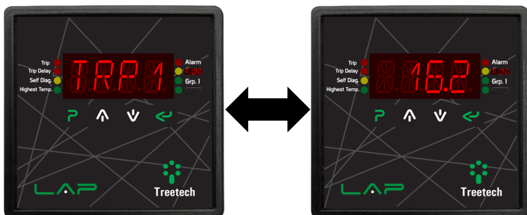
Figura 25 - Indicación de cuenta regresiva para apagar
