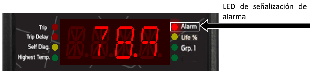
Figura 23 - Indicación de LED de señalización de alarma
