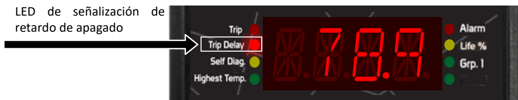
Figura 24 - Indicación de LED de retardo de apagado
