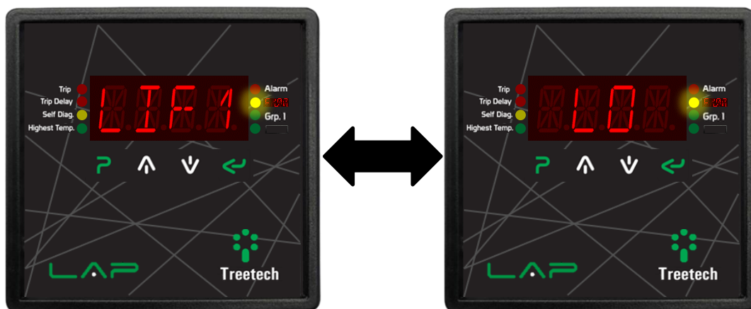
Figura 32 - Pantalla de alarma de porcentaje de vida restante baja
