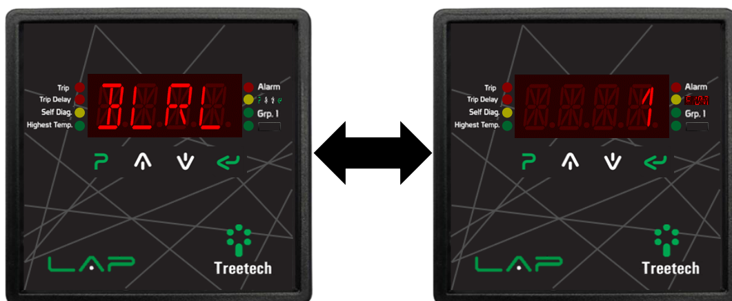
Figura 12 - Pantalla que indica la versión de lanzamiento de bootloader
