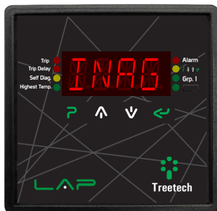
Figura 18 - Pantalla indicando la opción INAG activa
