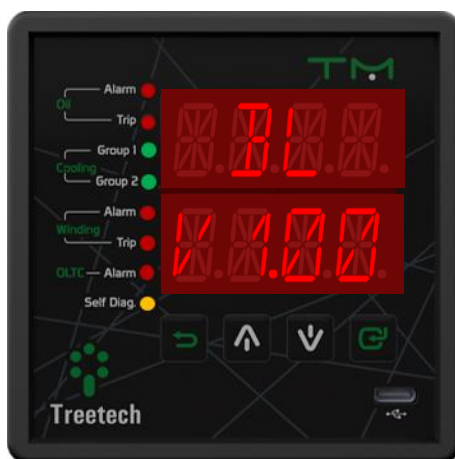
Figura 14 - Display indicando versão do bootloader
