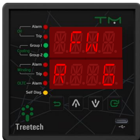
Figura 13 - Display indicando versão de release do firmware
