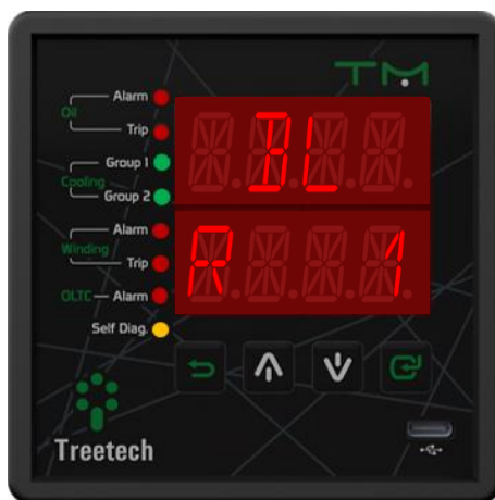
Figura 15 - Display indicando versão de release do bootloader
