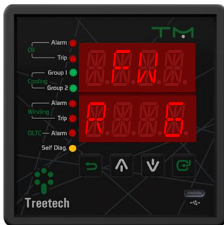
Figura 13 - Display indicando versão de release do firmware
