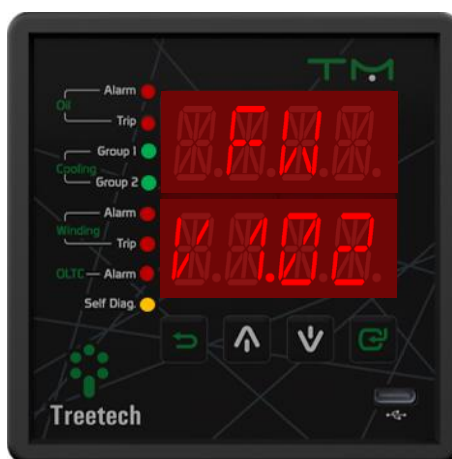
Figura 12 - Display indicando versão de firmware
