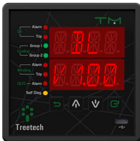
Figura 14 - Display indicando versão do bootloader
