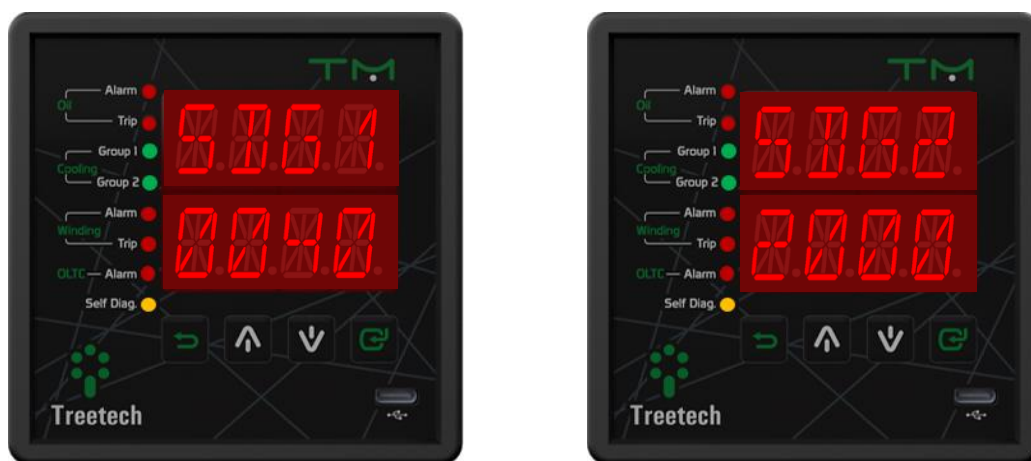
Figura 19 - Indicação de autodiagnóstico no TM
