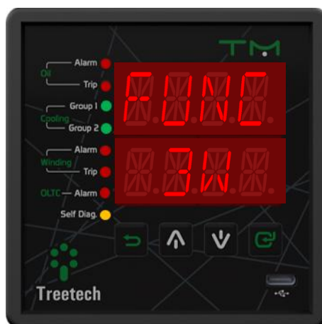
Figura 16 - Display indicando o número de enrolamentos
