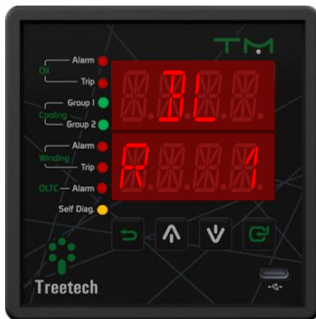
Figura 15 - Display indicando versão de release do bootloader
