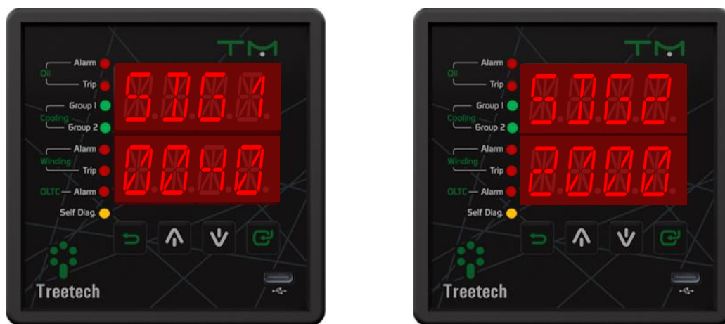
Figura 19 - Indicação de autodiagnóstico no TM
