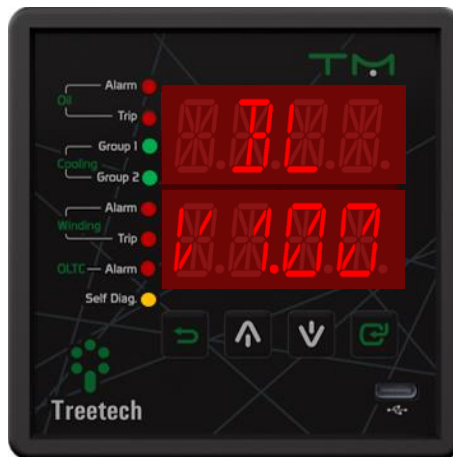
Figura 14 - Display indicando versão do bootloader
