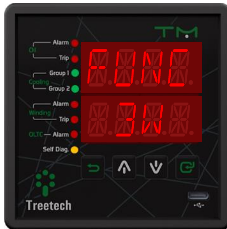
Figura 16 - Display indicando o número de enrolamentos
