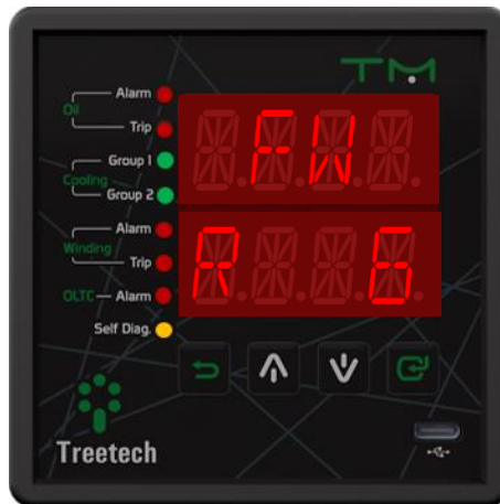
Figura 13 - Display indicando versão de release do firmware
