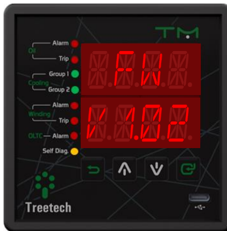
Figura 12 - Display indicando versão de firmware
