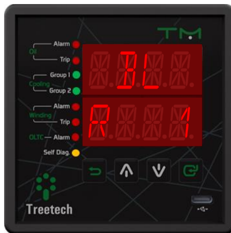
Figura 15 - Display indicando versão do release do bootloader
