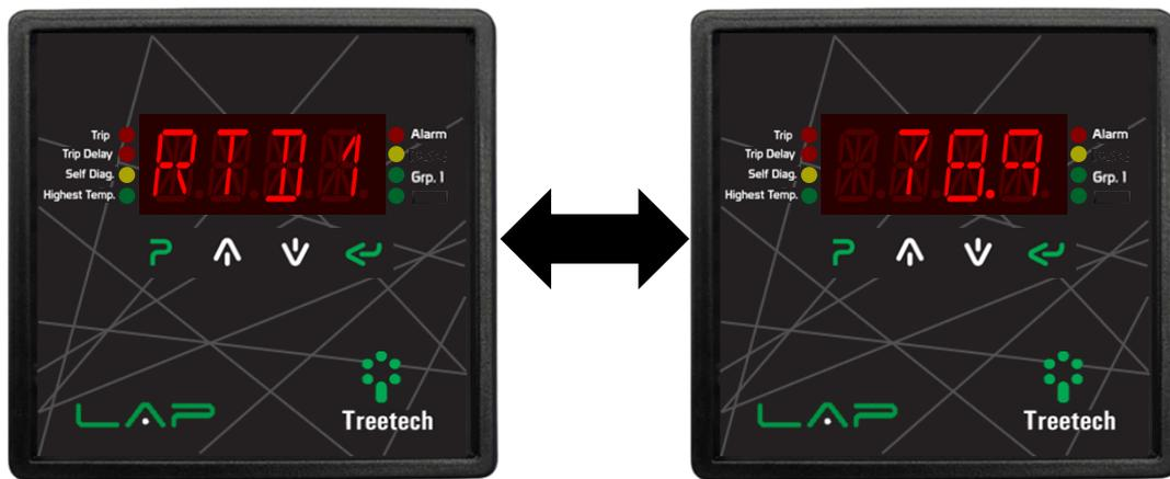
Figura 21 - Indicações de temperaturas no display
