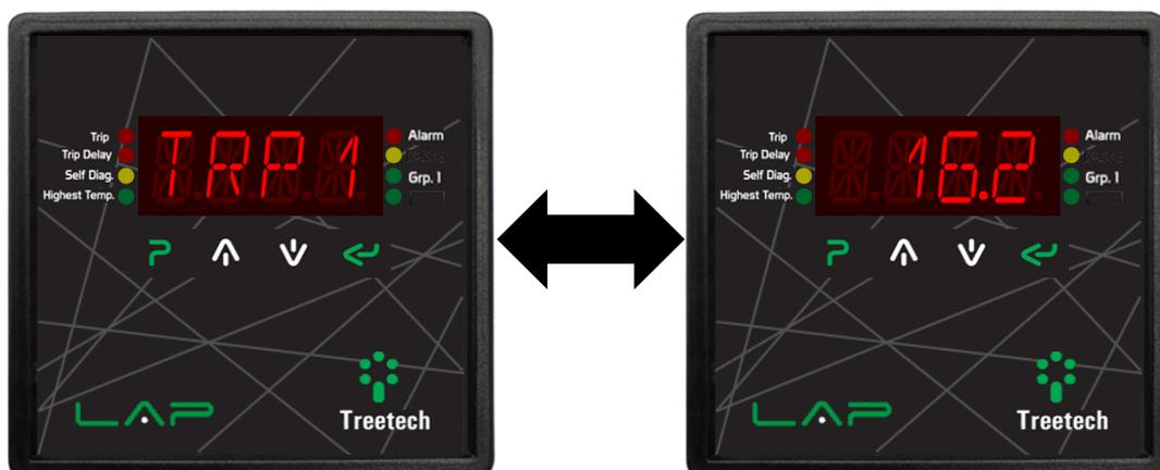
Figura 25 - Indicação de contagem regressiva para desligamento
