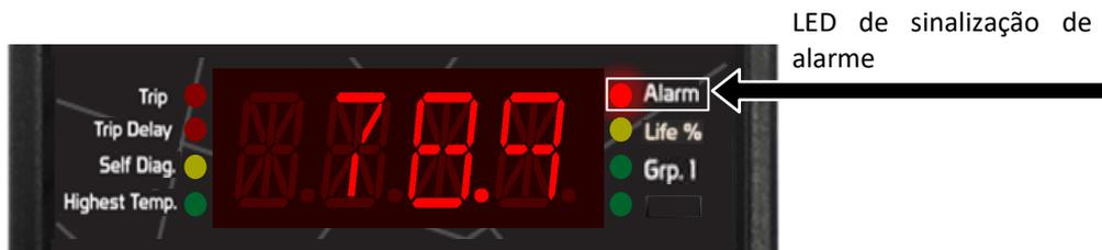
Figura 23 - Indicação de LED de sinalização de alarme
