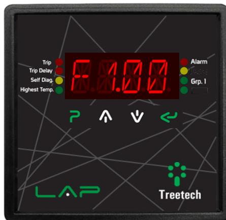
Figura 9 - Display indicando versão de *firmware*
