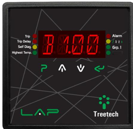
Figura 11 - Display indicando versão do *bootloader*
