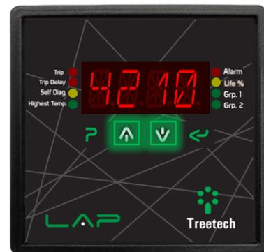
2) Utilizando as teclas **Up** e **Down**, ajuste a senha.
