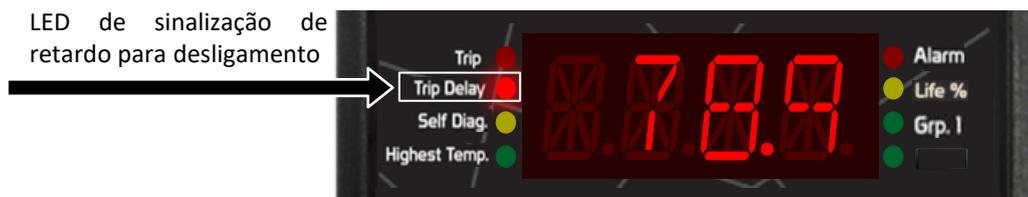
Figura 24 - Indicação de LED de sinalização de retardo para desligamento
