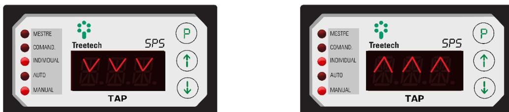
Figura 27 - Display indicando subida ou descida de tap
