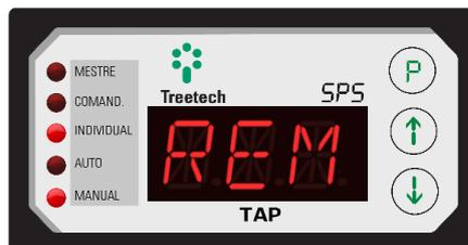
Figura 26 - Display indicando funcionamento no modo remoto
