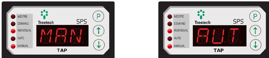
Figura 24 - Display indicando funcionamento no modo manual (MAN) ou automático (AUT)
