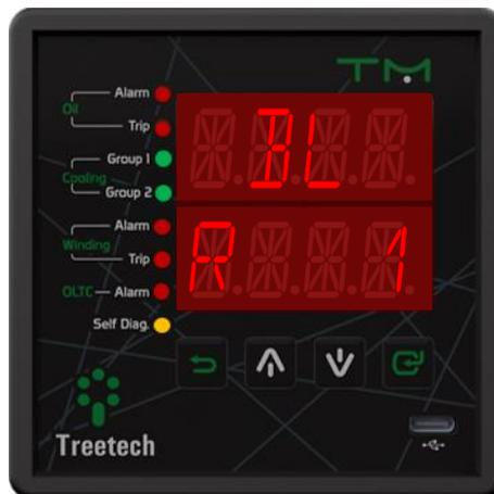
Figura 15 - Display indicando versão do release do bootloader
