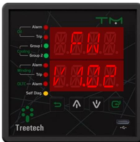
Figura 12 - *Display* indicando versão de *firmware*
