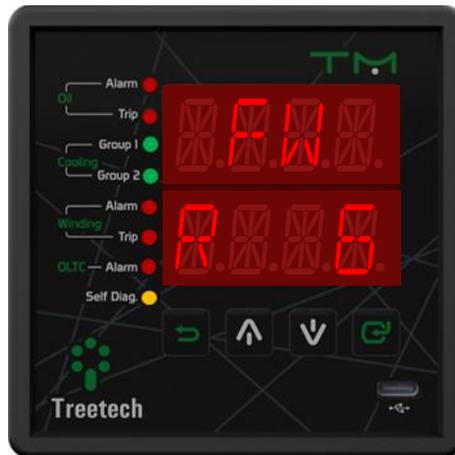
Figura 13 - Display indicando versão de release do firmware
