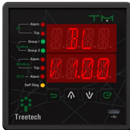
Figura 14 - Display indicando versão do bootloader
