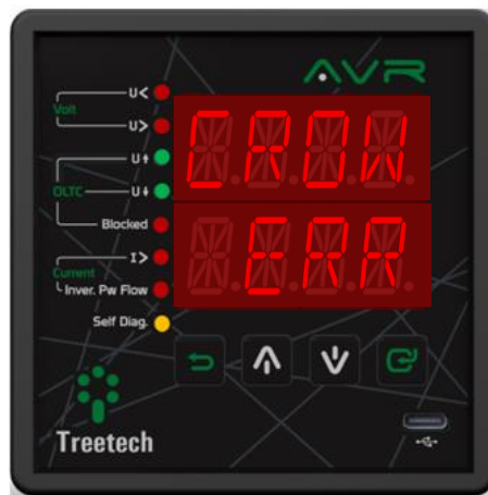
Figura 25 – Indicação de autodiagnóstico da coroa potenciométrica
