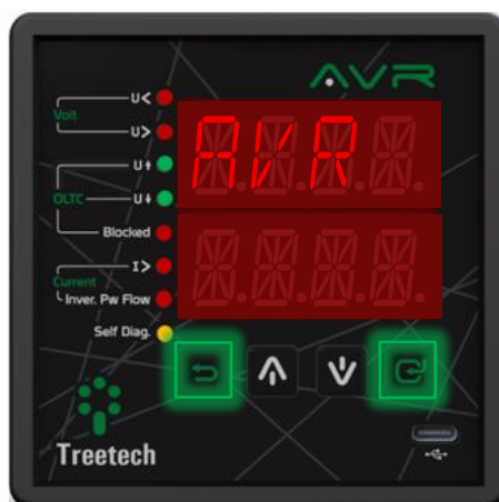
Figura 16 - Comando para acessar as informações do equipamento
