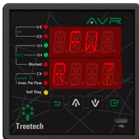
Figura 18 - Display indicando versão de release do firmware
