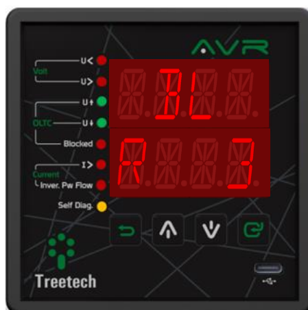
Figura 20 - Display indicando versão do release do bootloader
