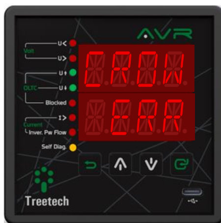
Figura 25 – Indicação de autodiagnóstico da coroa potenciométrica
