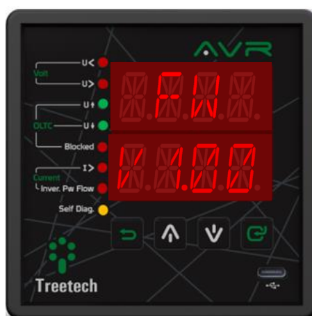
Figura 17 - Display indicando versão de firmware
