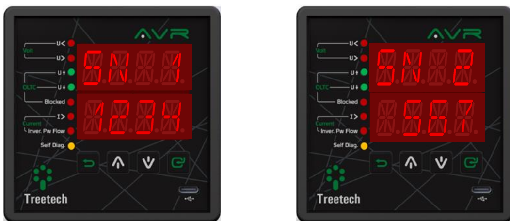
Figura 21 - Display indicando parte 1 e parte 2 do número de série
