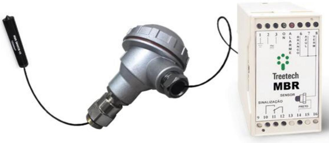
El **Relé de Rotura de Membrana/Bolsa – MBR** es un dispositivo capaz de detectar la rotura de la membrana o bolsa de caucho utilizada en sistemas de preservación de aceite en transformadores y reactores de potencia.
