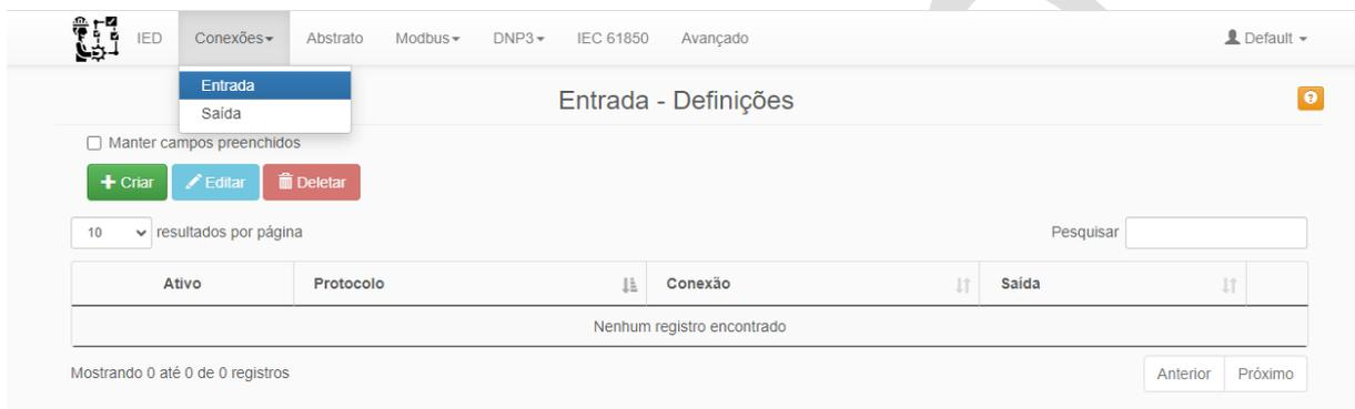
Figura 40 – Área de configuração → Conexões → Entrada
