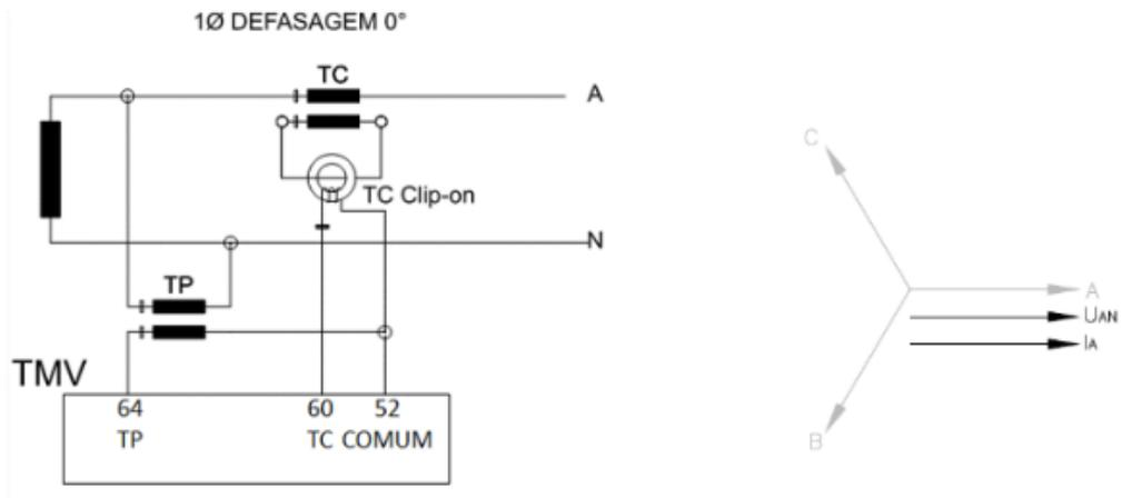
Figura 14 – Ligação para transformador monofásico, defasagem 0°
