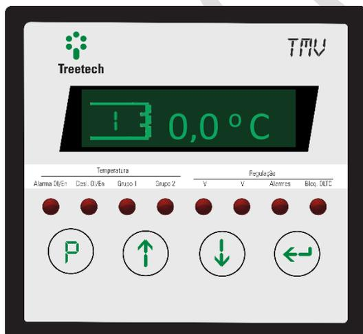
**TEMP. DO ENR. 1:** Indica a temperatura do primeiro enrolamento do transformador.
