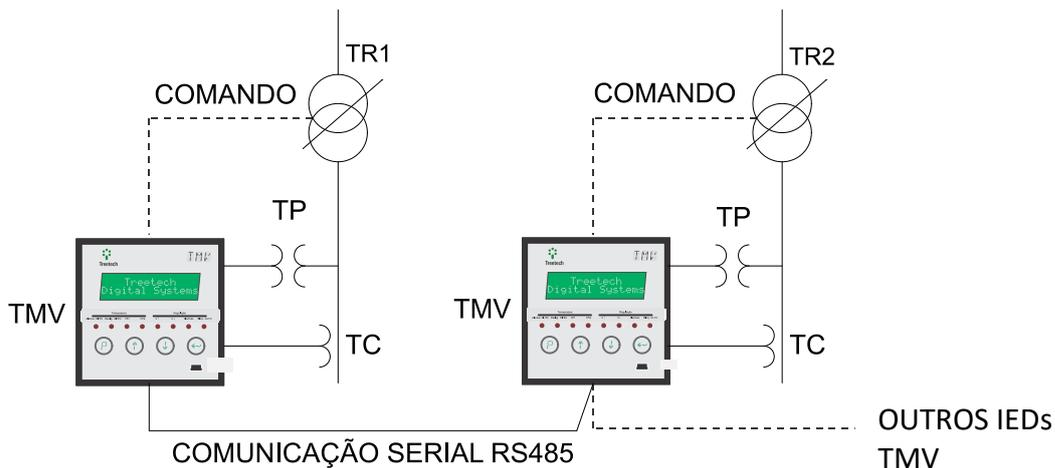
**Figura 5 – Aplicação do TMV com controle de paralelismo por Corrente Circulante**
