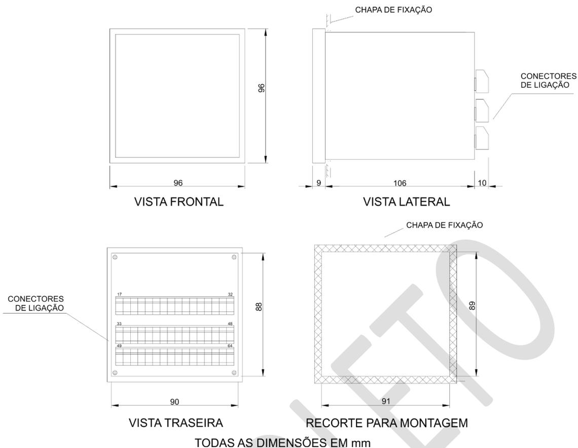
**Figura 8 - Dimensões do TMV**
