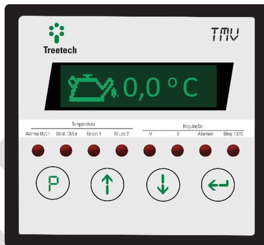
**TEMP. DO ÓLEO:** Indica a temperatura do óleo do transformador.
