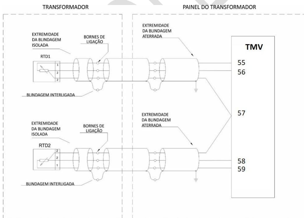
Figura 13 – Conexão da blindagem da interligação entre sensores RTD e o TMV
