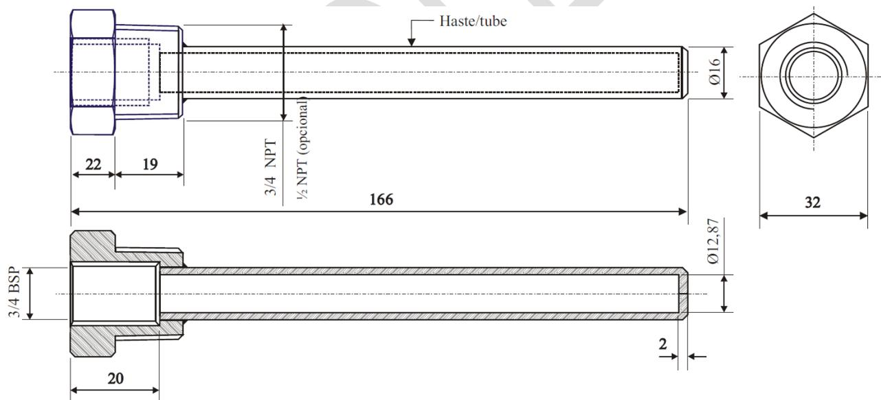
Os poços são fabricados em aço inox 304, material muito resistente à corrosão e muito utilizado como proteção em temperaturas de até 900 °C. As dimensões da figura acima estão em mm.
