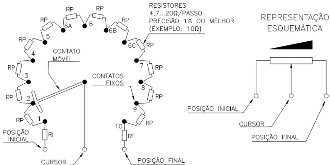
**Figura 11 – Config. dos resistores do transmissor potenciométrico nas posições intermediárias do CDC**
