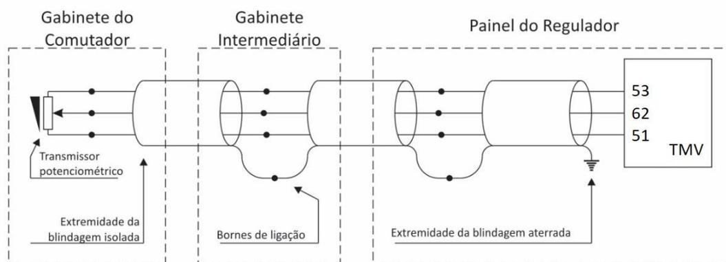
Figura 10 – Conexão da blindagem dos cabos de medição de tap
