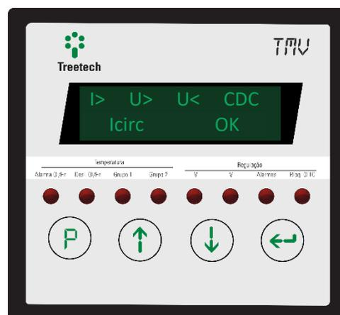
Quando ocorrer uma ou mais condições programadas nestes parâmetros, o TMV não emitirá qualquer comando para o CDC, bloqueando a ação de aumentar ou diminuir a tensão. A função de bloqueio do CDC pode ser associada a um contato de saída, que pode ser usado para interromper a alimentação de comando ou do motor do comutador, abortando até mesmo as operações já iniciadas no mecanismo de acionamento antes da operação dos contatos principais.
