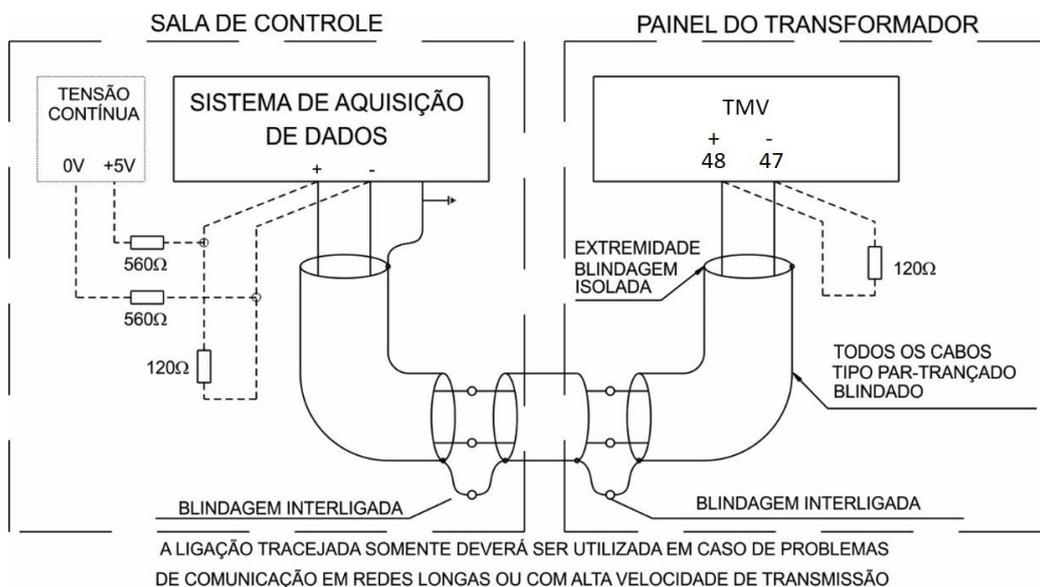
Figura 20 – Conexão e aterramento da blindagem da comunicação serial RS485
