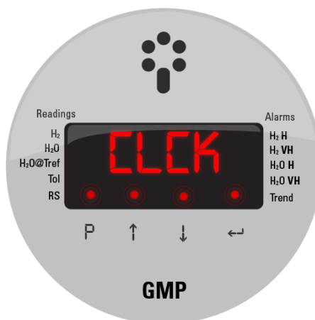
Figura 16 - Display indicando o menu CLCK
