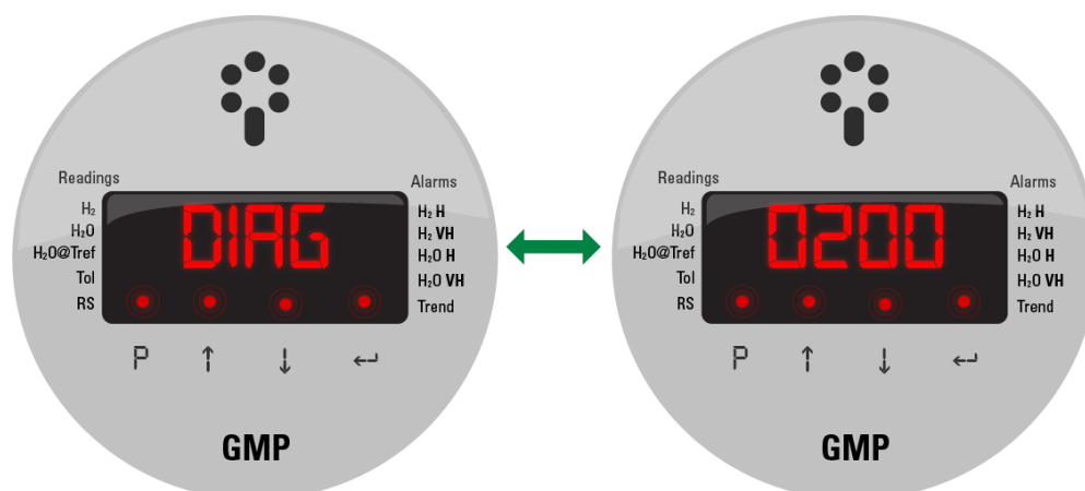
Figura 14 - Display de autodiagnóstico
