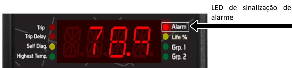
Figura 23 - Indicação de LED de sinalização de alarme
