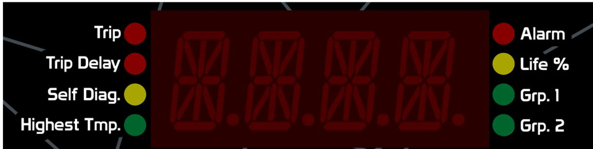
Figura 20 - LEDs de señalización del LAP
