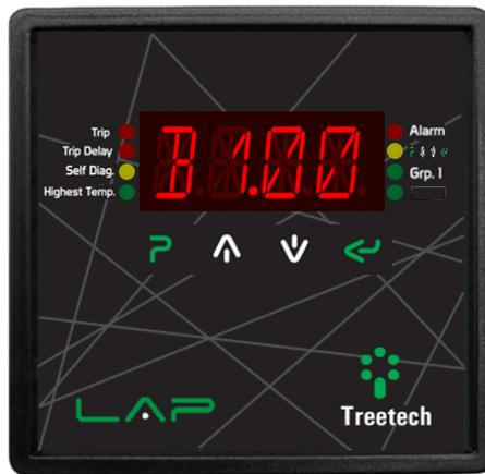
Figura 11 - Pantalla que indica la versión de *bootloader*
