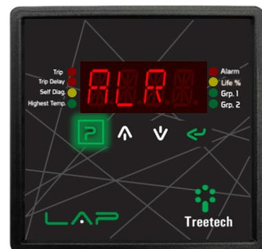
4) Se muestra el primer menú (ALR). Usar las teclas **↑** y **↓** para seleccionar un submenu y presione **←** para acceder a sus parámetros.
