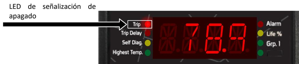
Figura 26 - LED de señalización de apagado
