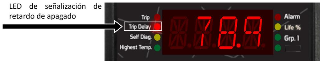
Figura 24 - Indicación de LED de retardo de apagado
