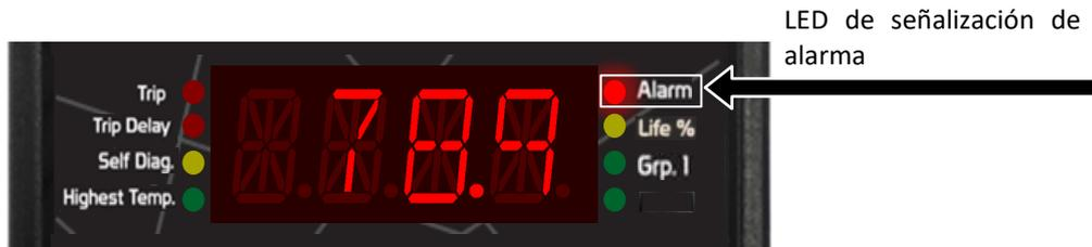
Figura 23 - Indicación de LED de señalización de alarma
