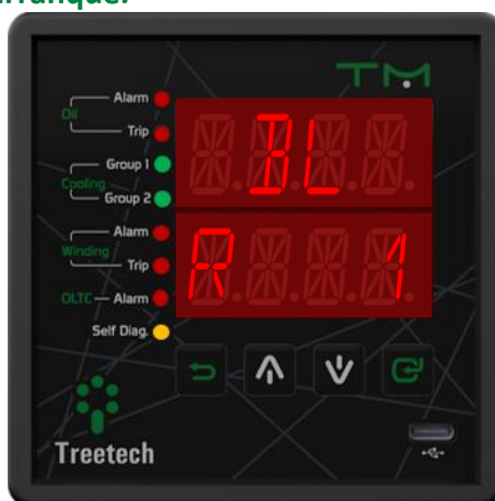
Figura 15 - Pantalla que indica la versión de lanzamiento del gestor de arranque
