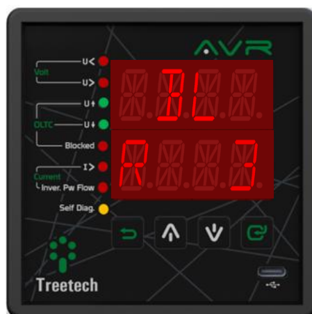
Figura 20 - Display indicando versão do release do bootloader
