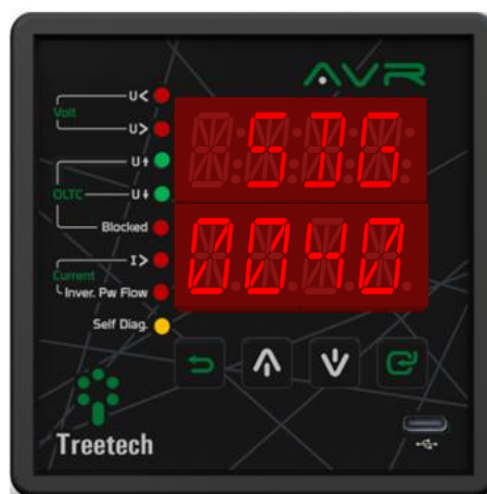
Figura 24 - Indicação de autodiagnóstico no AVR
