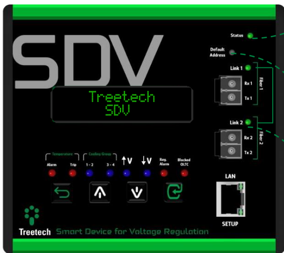
Figura 26 – Disposição e função dos LEDs
