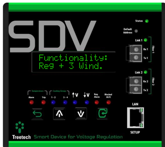
Figura 35 – Display indicando funcionalidade do sistema
