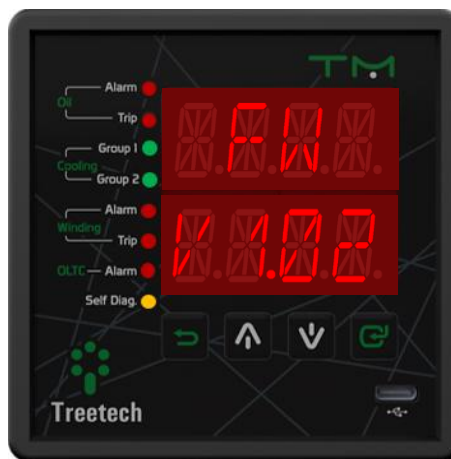
Figura 12 - Pantalla que indica la versión del firmware
