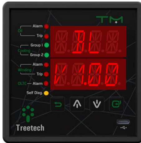
Figura 14 - Pantalla que indica la versión del gestor de arranque
