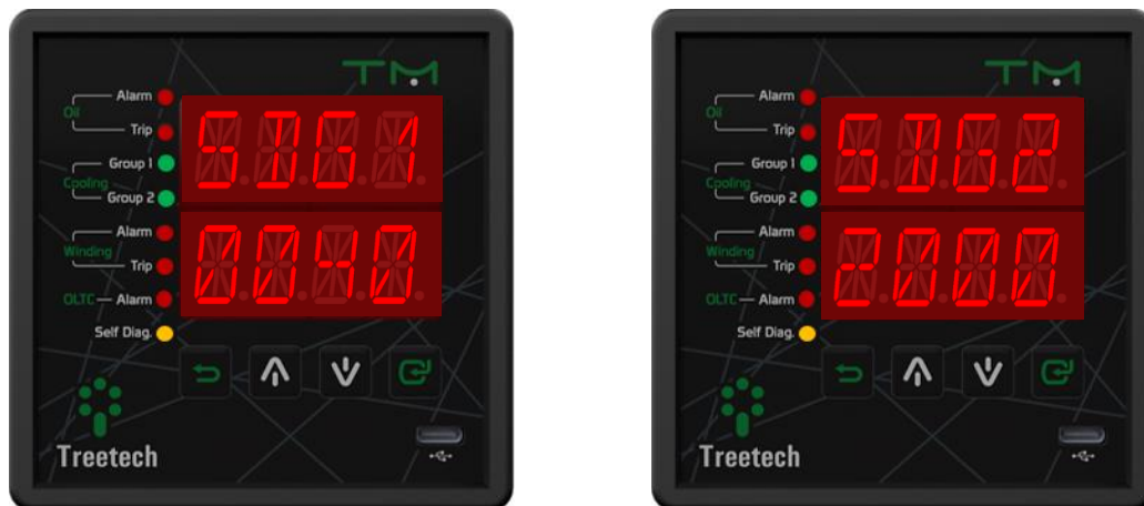
Figura 19 - Indicación de autodiagnóstico en el TM
