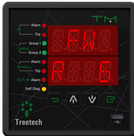
Figura 13 - Pantalla que indica la versión de lanzamiento del firmware
